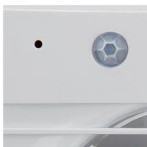
Модель оснащена инфракрасным датчиком движения и регулируемым таймером (1-30 мин.). Вентилятор включается автоматически, когда датчик фиксирует движение в радиусе 4 метров от вентилятора и выключается по прошествии времени, заданного на таймере. Угол обзора датчика движения составляет около 90°.
