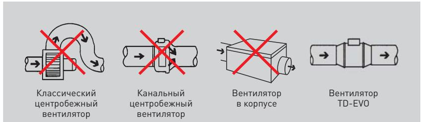
Компактная конструкция и высокая производительность вентиляторов TD-EVO делает их незаменимыми при монтаже в ограниченном пространстве, например, за подвесным потолком.
