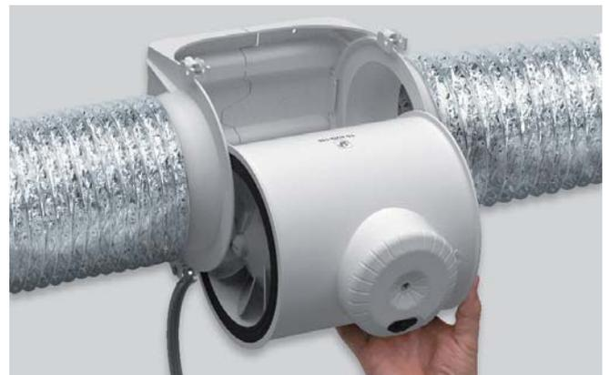
Уникальная конструкция вентилятора позволяет извлекать блок двигатель-крыльчатка без демонтажа воздуховодов, что делает обслуживание вентилятора легким и быстрым.
